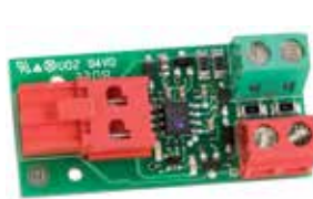
Interfejs BUS XIB (do panelu sterującego E024S lub bez fotokomórki BUS)
