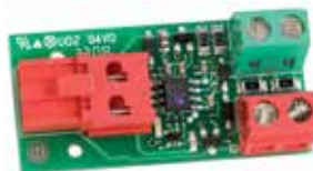
Interfejs BUS XIB (do panelu sterującego E024S lub bez fotokomórki BUS)
