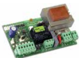
Wbudowana centrala sterująca 596/615 BPR Specyfikacja techniczna str. 122
