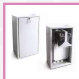
COL.KSUN 1805zł 9252060 Skrzynka do akumulatora DA.BT18 i centrali SUNNY.LB. Wyposażona w regulowaną półkę pod akumulator. H=650x323x230mm
